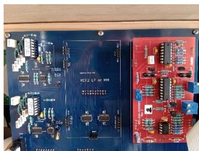
Pour remettre un autre filtre, aligner les connecteurs, si possible en commençant par le connecteur du bas de la carte, puis aligner l'ensemble des points de contact et enfoncer en butée le circuit, les cartes doivent être alignées avec la sérigraphie sous-jacente, puis refermer la face arrière si besoin.
